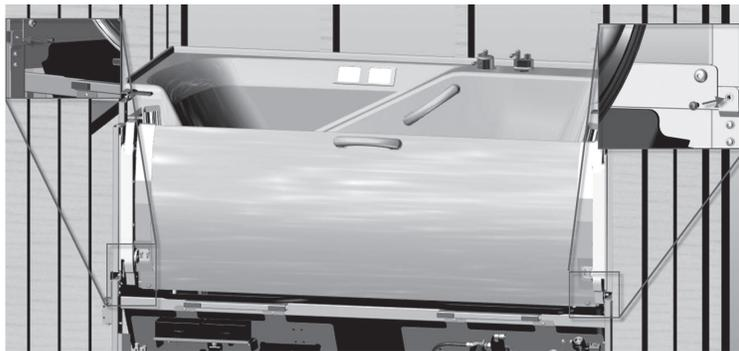
4.3.6. À l'aide d'une clé Allen de 5/32, retirer les 3 boulons retenant l'équerre de transport de la porte ; faire la même chose de l'autre côté. Conserver les boulons fixés à la structure pour usage ultérieur. Remettre en place les 4 boulons fixés à la porte.
