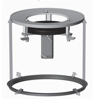
4.4.1. Déposer le drain à l'envers dans la baignoire sur le carton ou la serviette déposée plus tôt.
