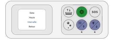
10. En utilisant les flèches, sélectionner « Mode auto » et appuyer sur le bouton de sélection.
