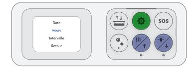
7. En utilisant les flèches et le bouton de sélection, sélectionner l'heure à laquelle vous voulez commencer la séquence de nettoyage.
