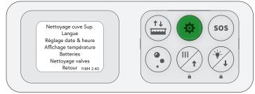
2. En utilisant les flèches, sélectionner « Nettoyage valves » et appuyer sur le bouton de sélection.
