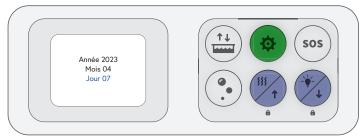
En utilisant les flèches, sélectionner « Heure » et appuyer sur le bouton de sélection.
