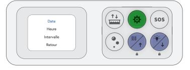
5. En utilisant les flèches et le bouton de sélection, sélectionner la date à laquelle vous voulez commencer la séquence de nettoyage.
