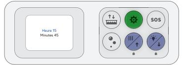
9. En utilisant les flèches et le bouton de sélection, sélectionner la fréquence à laquelle vous voulez que la séquence de nettoyage s'exécute.
